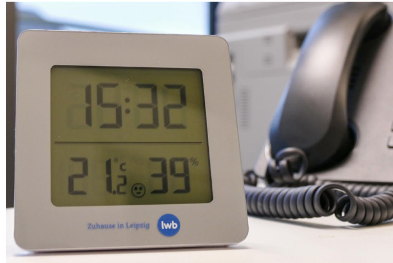
Mit Hygrometern wie dem von der LWB lässt sich die relative Luftfeuchtigkeit bestimmen. Optimal sind Werte zwischen 40 und 60 Prozent.
