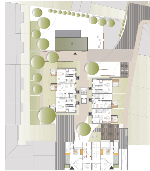
Wohnungsgrundriss des Erdgeschosses mit Coworking-Area
