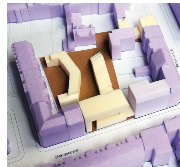
Schließung des Blockrandes durch bauliche Verzahnung
